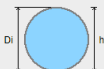
Figur 33 Kapasitetsberegning 1000mm rør med 3% fall, 4756l/s
