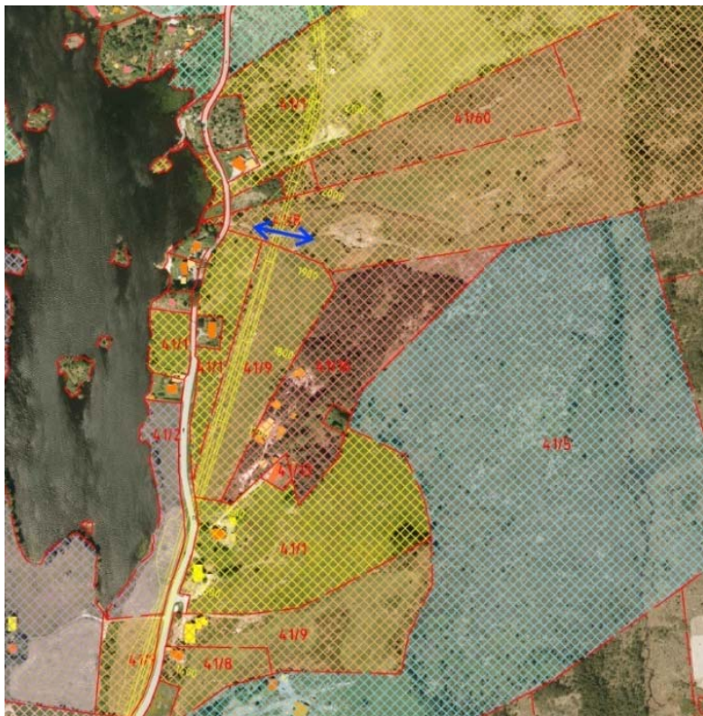
Figur 36 Ved ca. profil 1930 går vegen i alternativ B2 og B3 i større fylling over turveg/traktorveg. Her vil det vere gunstig å etablere "krøterundergang", indikert med blå pil.
